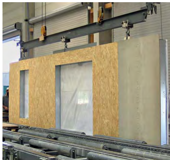
Links: Befestigung der aussteifenden Beplankung mit ballistischen Nägeln Rechts: Für den Transport bereitstehendes vorgefertigtes Wandelement
