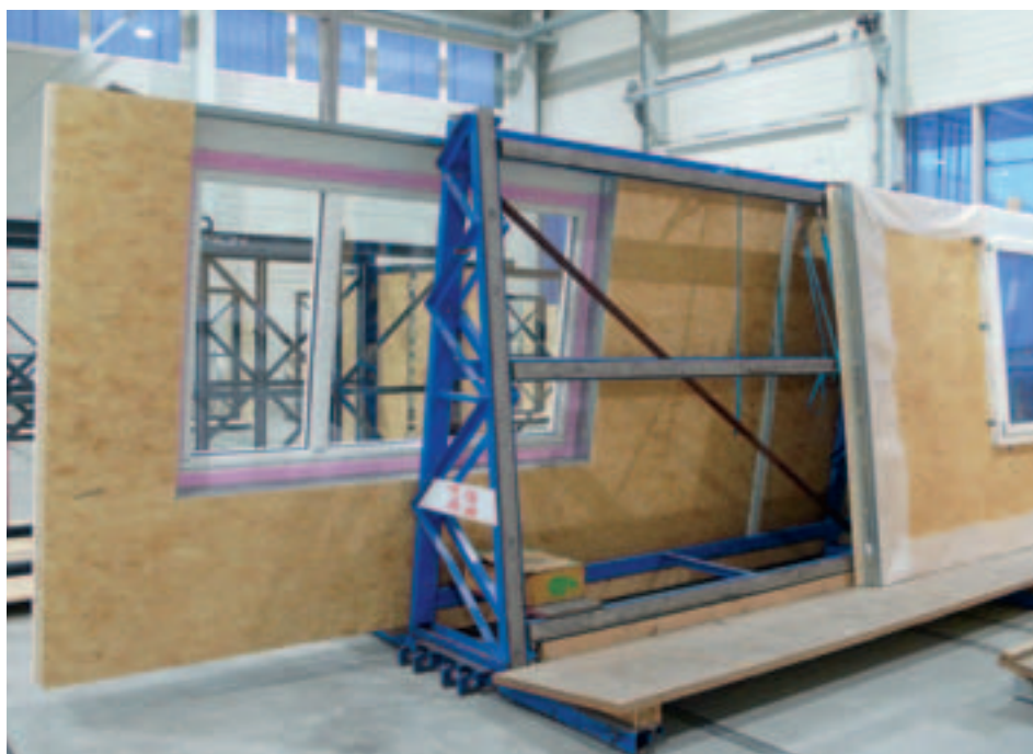
Abb. 3: Fertige Fassadenelemente mit Fenster
