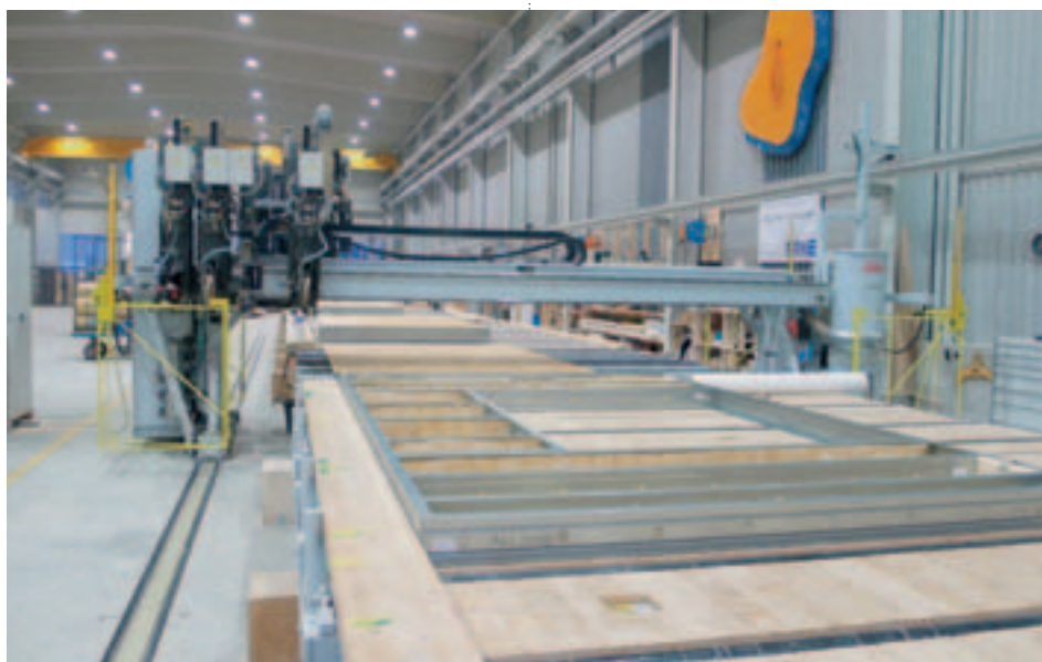
Abb. 2: Erstellung der Fassadenelemente auf einer Weinmann-Multifunktionsbrücke bei der Erne AG Holzbau
